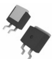
IXTA36P15P IXYS MOSFET P-CH 150V 36A TO-263
