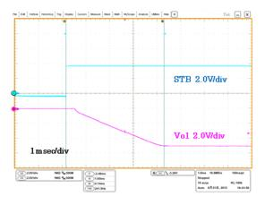
Figure 28. CH1 Soft start waveform
